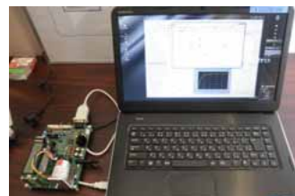
図 4 SIMULINK で動く DC モータ実験装置
