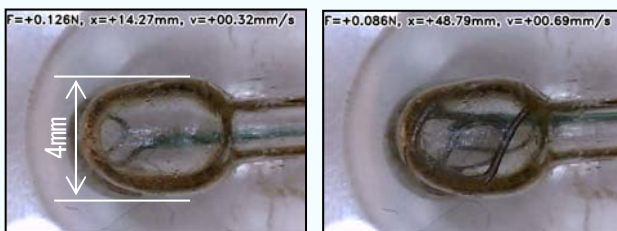
シリコン製の模擬動脈瘤へのコイル挿入中の画像
