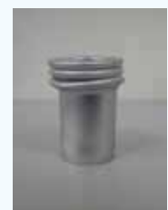
円形パイプの衝撃圧縮試験後の座屈変形の例 (3個のしわ状変形の形成)
