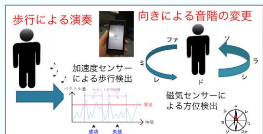
図4 音楽生成アプリの音楽生成原理
