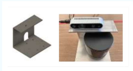
治具に固定した画像認識カメラと距離センサ
