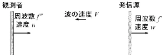
Fig.3 移動体反射波のドップラー効果
