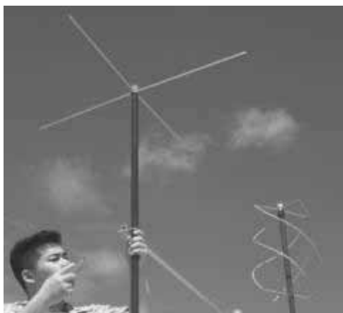
Fig.2 自作アンテナの例 左: ターンスタイル型, 右: QFH 型
