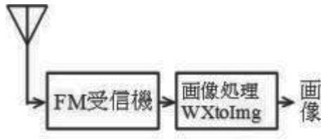
Fig.1 APT 信号受信の仕組み
