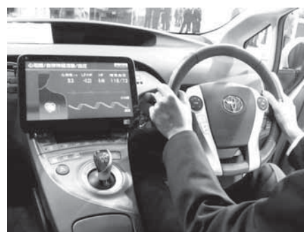
Fig.6 ステアリング把持型体調急変予兆検出システム [24]
