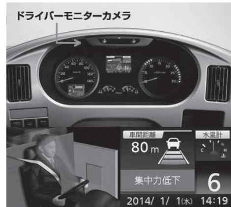
Fig.1 ドライバモニターカメラの搭載例（日野自動車株式会社，セレガ） [11]
