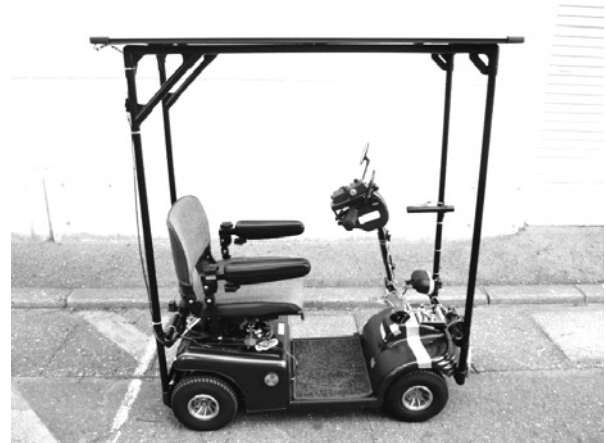
Fig.3 ソーラーシステムを取り付けたシニアカーの外観
