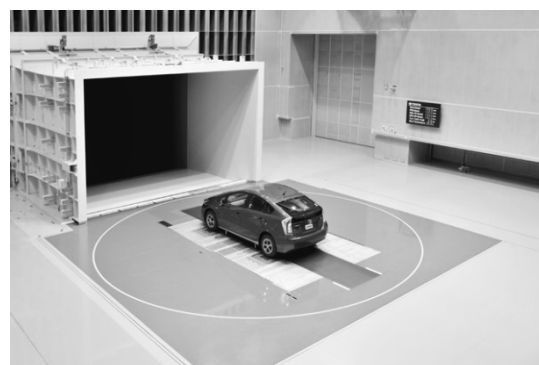
Fig.3 トヨタ5ベルト式ムービングベルト
